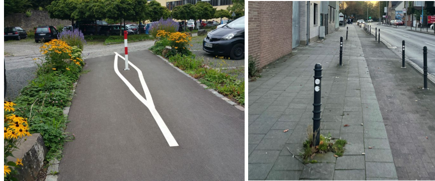
Abbildung 4-26: markierter Sperrpfosten auf Radroute in Engelskirchen (links) und zur Unterbindung illegalen Kfz-Parkens in Dormagen (rechts)
