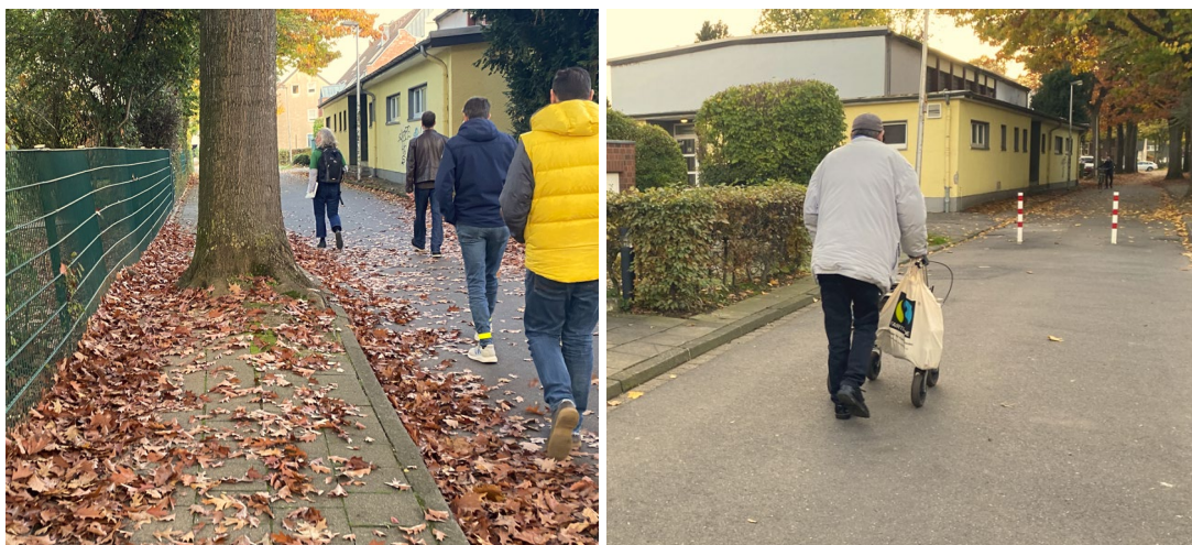
Abbildung 4-29: fehlende Nebenanlagen zwingen zu Fuß Gehende auf die Fahrbahn
