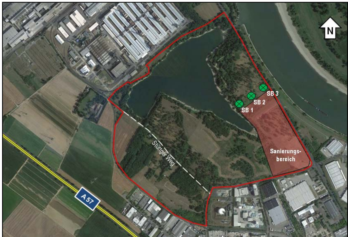
Abb. 8.3: Mögliche Lagen von Sicherungsbrunnen
