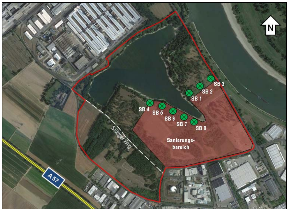
Abb. 8.6: Mögliche Lage der Entnahmebrunnen für eine Pump+Treat-Maßnahme
