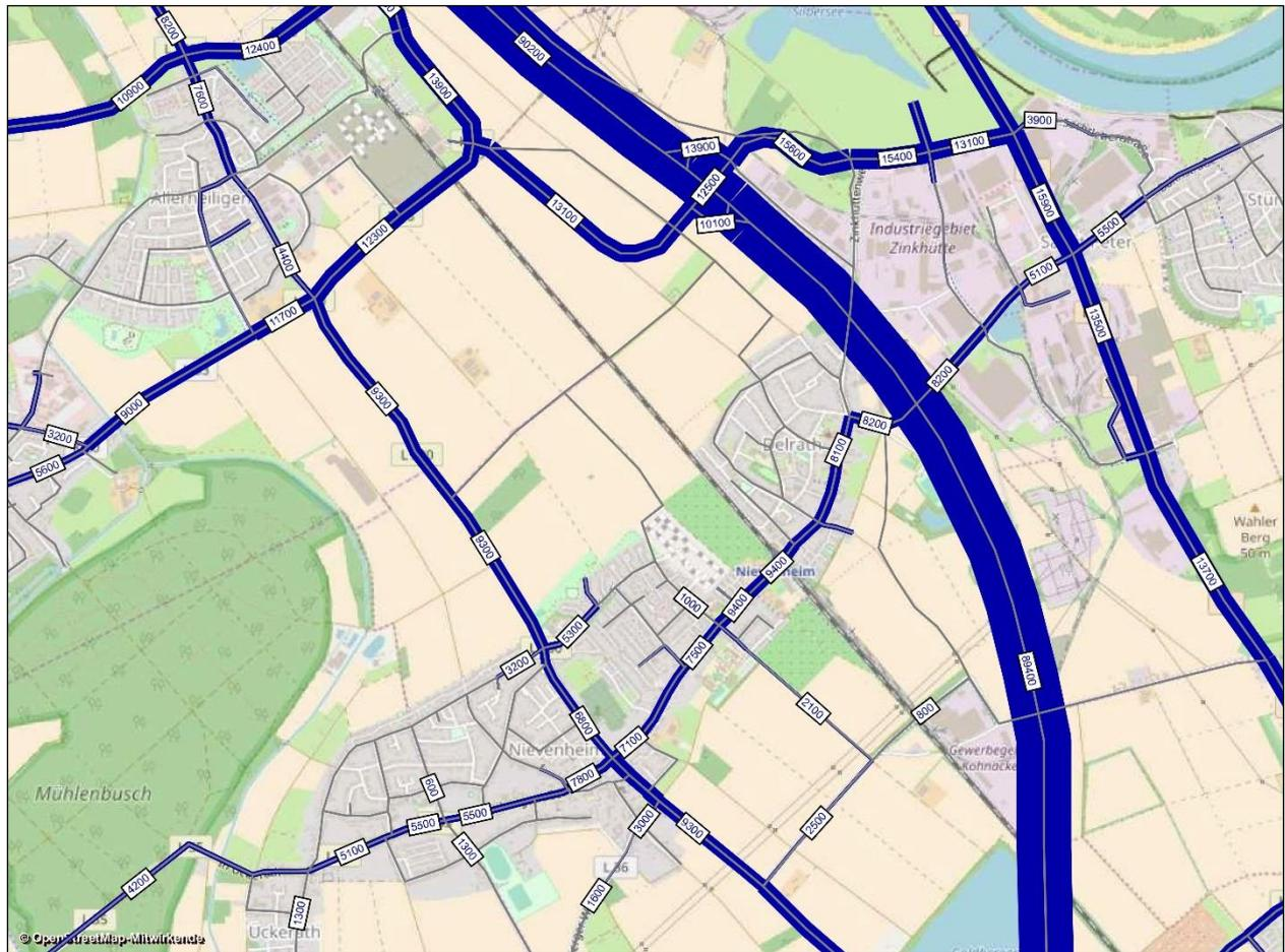
**Abbildung 16:** Verkehrsbelastungen im Planfall 1 mit AS Delrath (V1a) [Kfz/24h]
