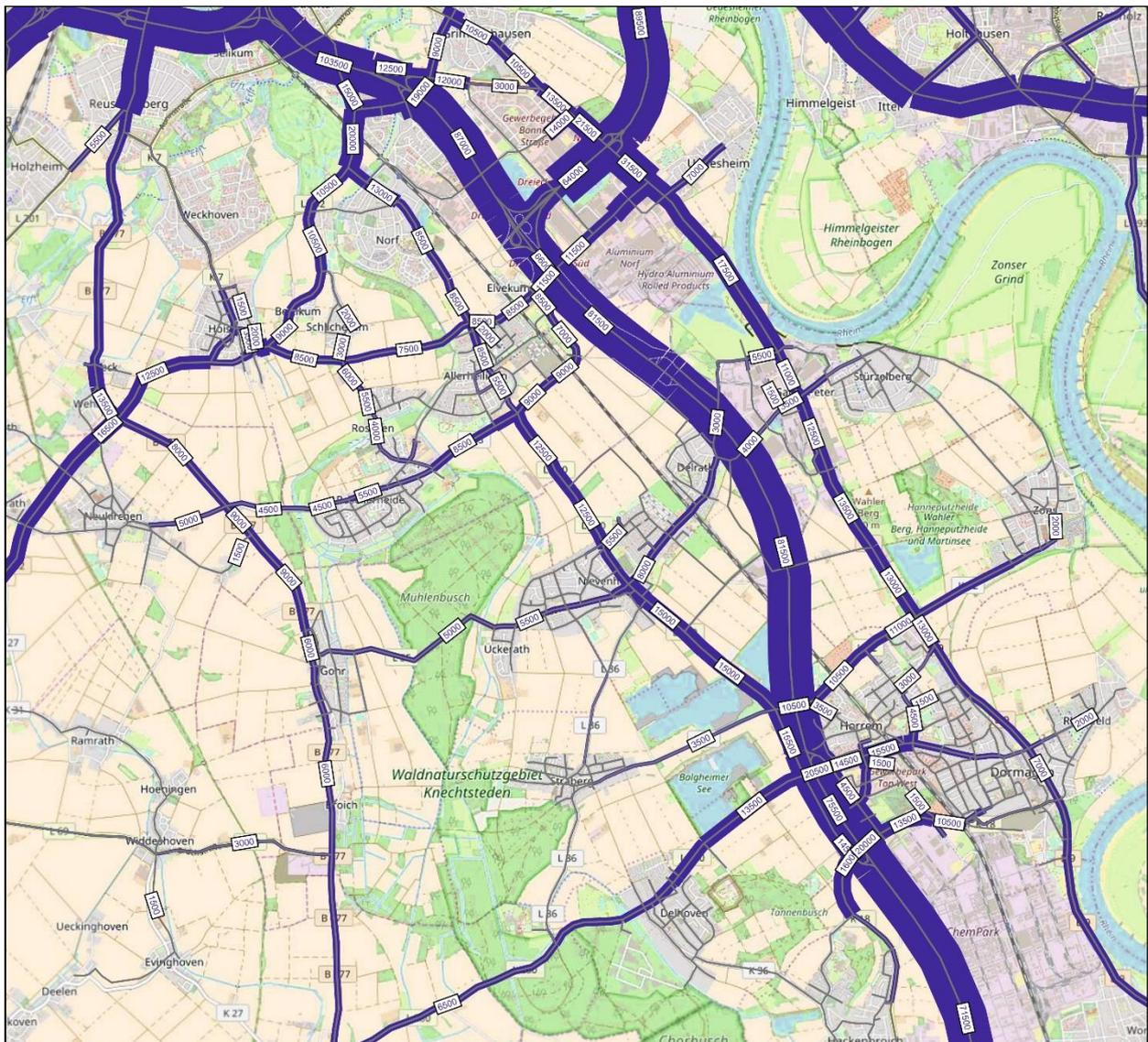
**Abbildung 4:** Verkehrsbelastungen Analyse [Kfz/24h]
