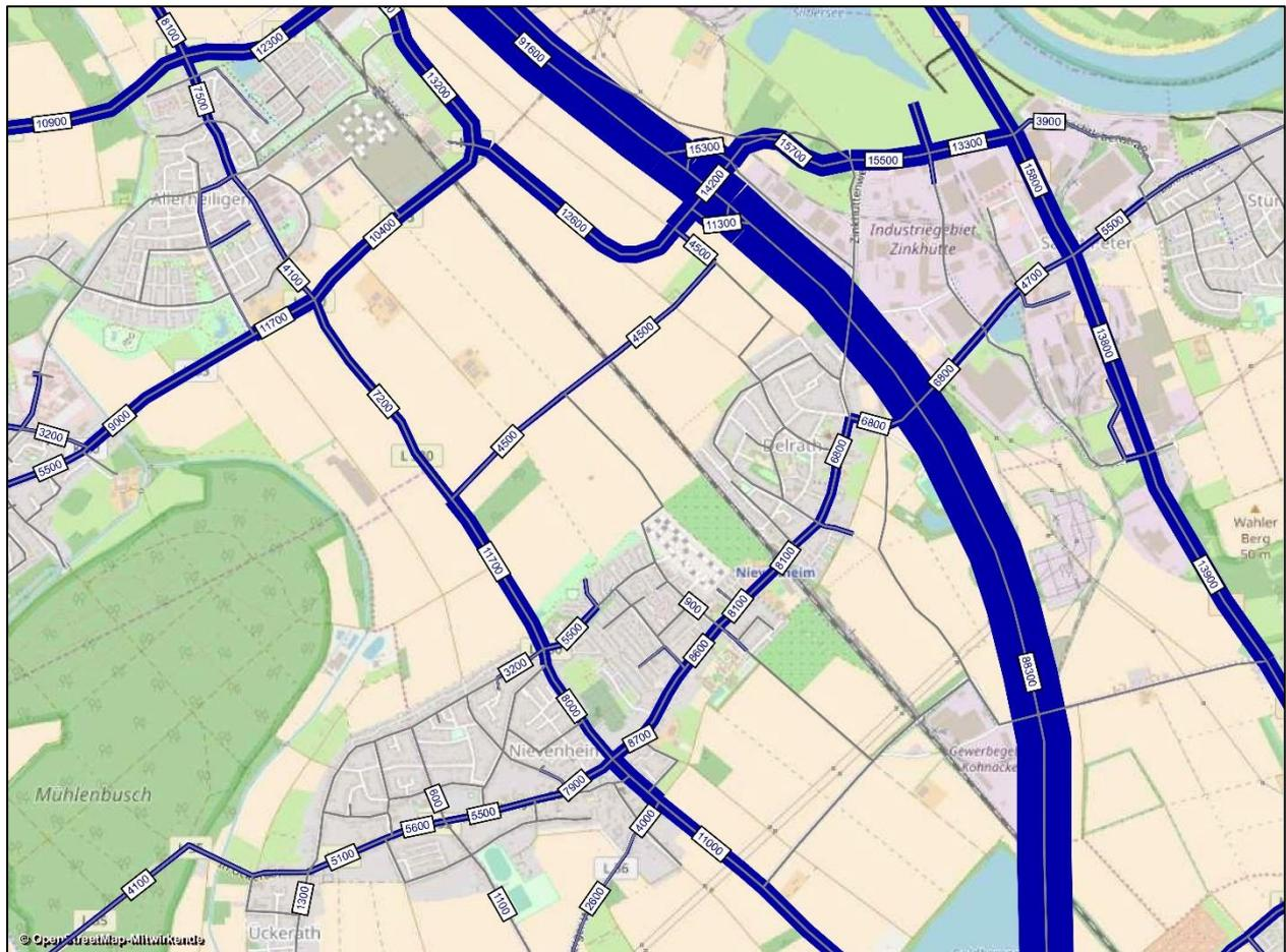
**Abbildung 30:** Verkehrsbelastungen im Planfall 4 mit AS Delrath (V1a) [Kfz/24h]
